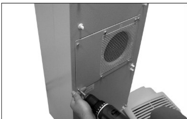
图67: 松开外部管路风扇上的四个螺钉
