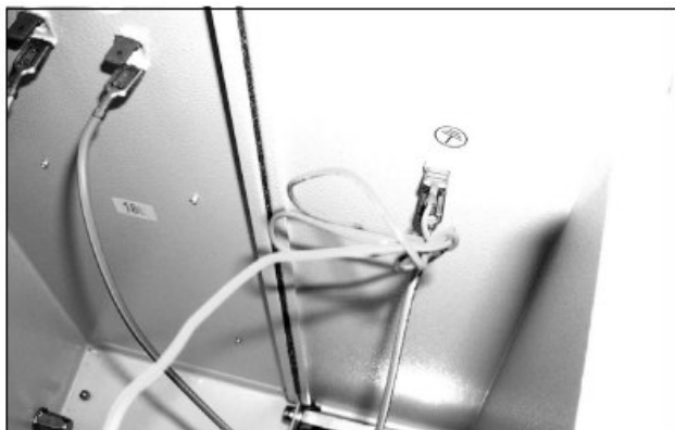
图72: 断开风扇接地电缆 (1)
