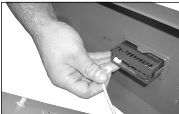
图64: 断开显示器电缆
