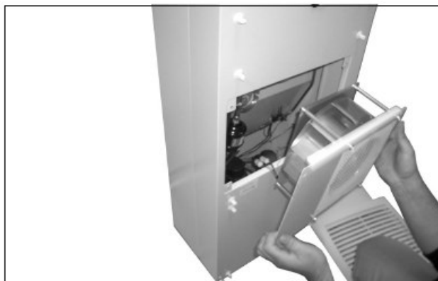
图68: 拆卸外部管路风扇
