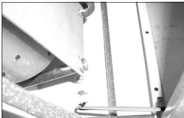
图53：松开盖子和底座之间的接地电缆（1）
