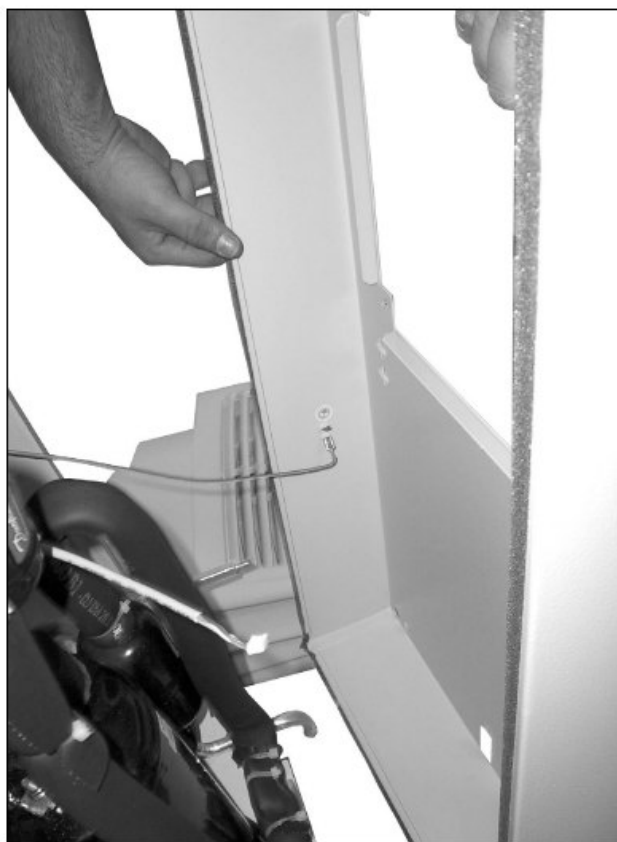
图76: 断开接地电缆 (1)
